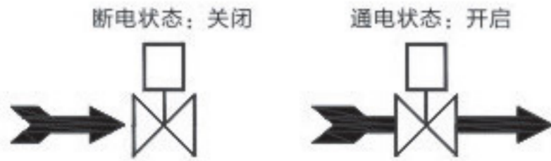
常闭电磁阀开关状态图
