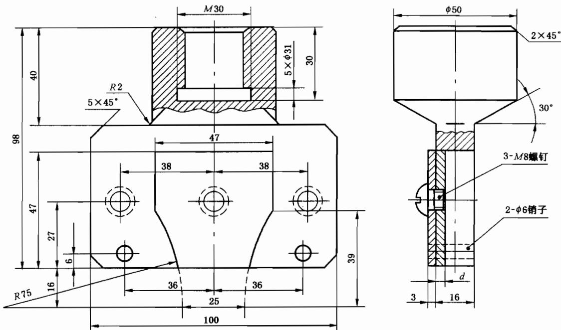
注：试样厚度为 6 mm 时，间隙板厚度  $d_2$  为 3 mm；试样厚度为 3 mm 时，间隙板厚度  $d_2$  为 5 mm。
