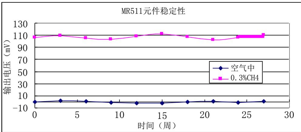
在空气中每年漂移小于 10mV，在 0.3%CH4 中每年漂移小于 10mV。短期储存 (两周内) 30 分钟即可稳定，如长期储存 (一年)，则需老化 5 小时才可稳定。
