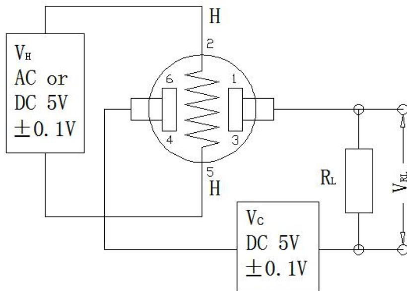
图 2 MQ138 测试电路
