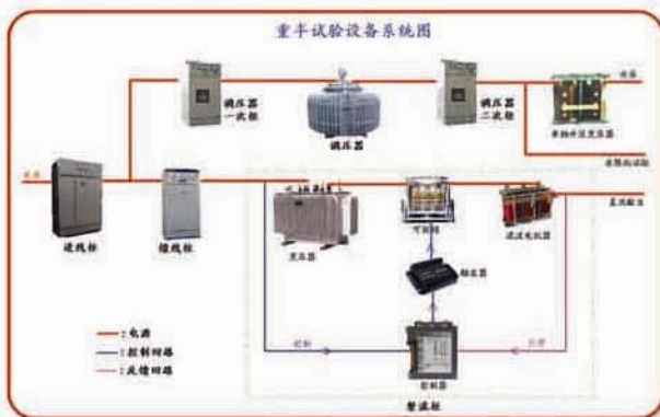
哈尔滨电机厂有限责任公司汽发分厂 重型半成品试验站控制系统图
