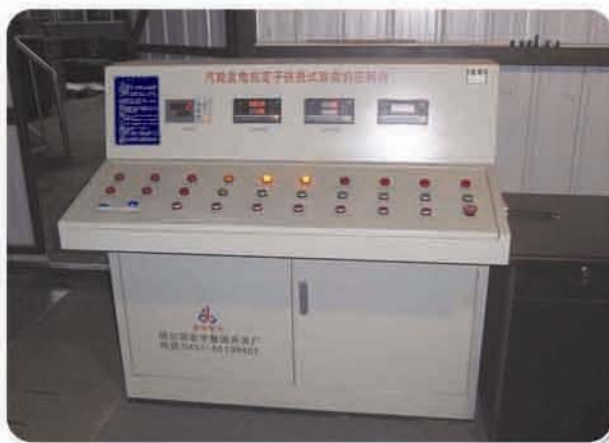
哈尔滨电机厂有限责任公司汽发分厂 大型汽轮发电机定子铁芯损耗试验智能微机控制台
