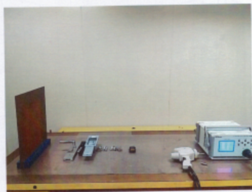
图三: 静电放电抗扰度和抗静电试验布置图
