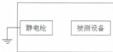
图四：静电放电抗扰度和抗静电试验被测设备的连接图
