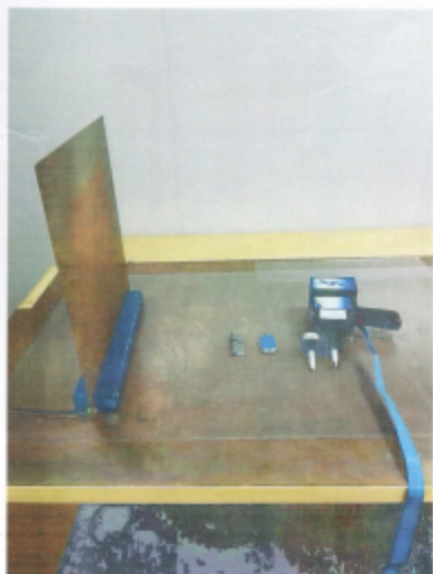
图三：静电放电抗扰度和抗静电试验布置图
